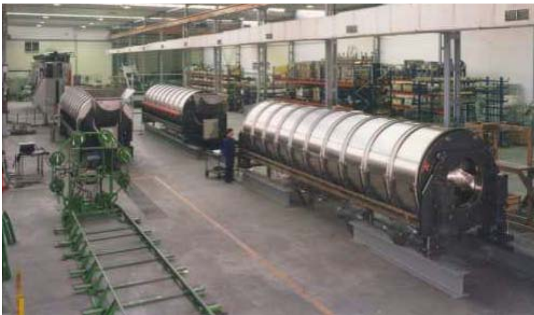
Figura 3.2 Túnel de lavado de Girbau S.A. (producto estructurado en módulos constructivos): a) Imagen seccionada donde se ve la estructura modular y los sistemas de apoyo y accionamiento; b) Planta de fabricación de túneles de Girbau S.A.
