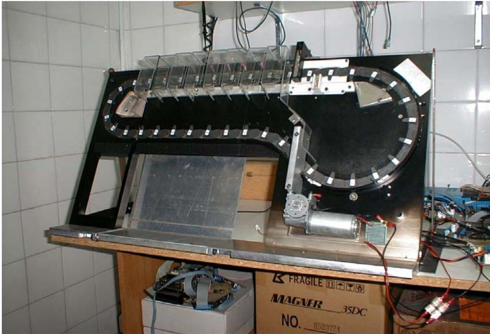
Figura 1.8 Diseño original: *Máquina universal de clasificar monedas*; prototipo funcional (Ibersélex S.A.)
